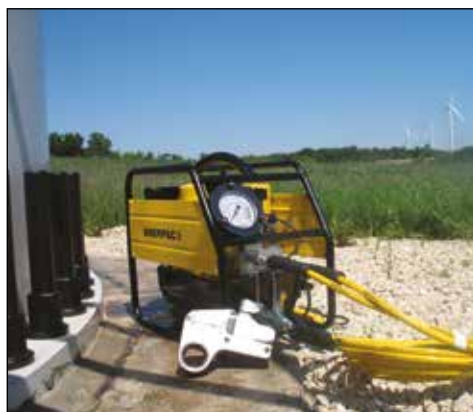
De TQ700E-pomp en W-serie momentsleutel zijn een productieve combinatie in toepassingen voor windenergie.
