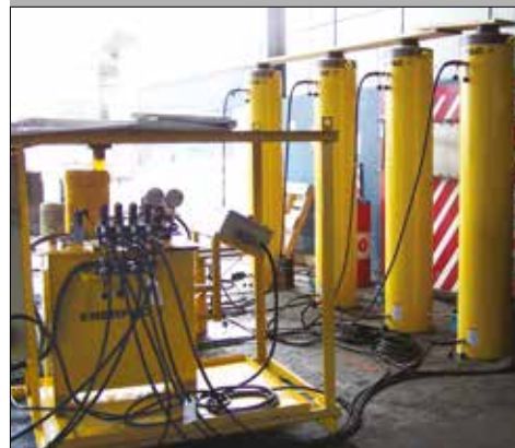
▲ Op maat gemaakte 500 ton dubbelwerkende cilinders met een slag van 1,83 m voor het heffen van kabelgraafmachines.
