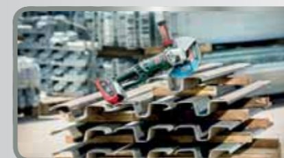
11 sneden door vangrails Materiaal: plaatstaal
